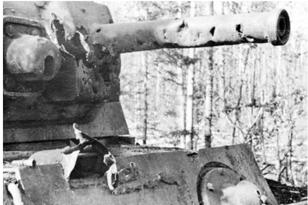
Фрагмент фотографии подбитого KV-8 одного из огнеметных танковых батальонов Волховского фронта. Сентябрь 1942 года. Хорошо видна форма бронирования огнемета, а также маскировочный кожух, установленный на ствол 45-мм орудия.
